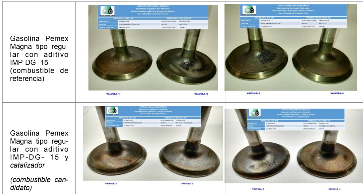
Figura 1. Depósitos en válvulas de admisión (IVD) ASTM D 6201-04
