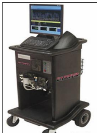
Figura 3.2. Analizador de gases HORIBE BE 140. Plan piloto para la estimación de la eficiencia energética y la reducción de emisiones como resultado de la aplicación de la Tecnología Green Plus. Valle de Aburrá, 2017
