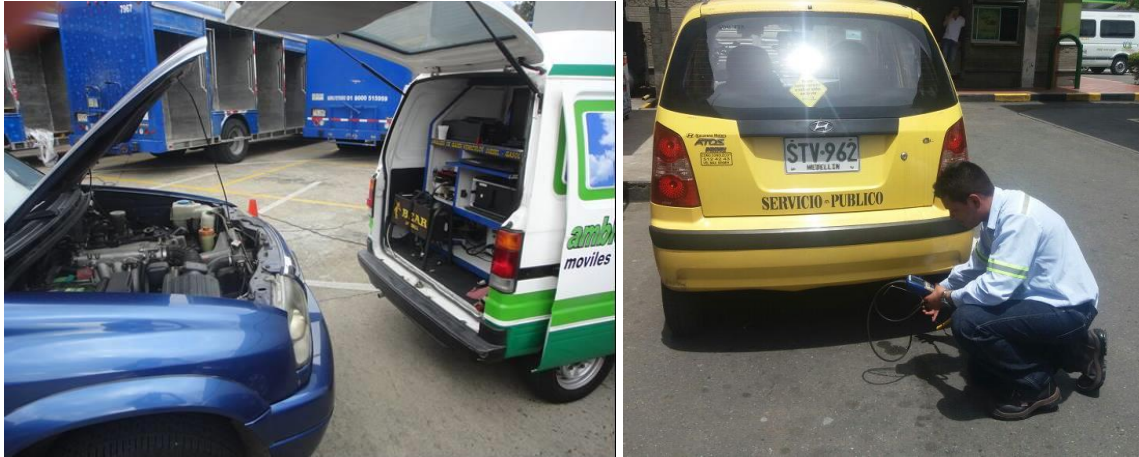
Figura 3.3. Medición de gases con analizador HORIBE BE 140 (Izquierda) y con analizador Kane (derecha). Plan piloto para la estimación de la eficiencia energética y la reducción de emisiones como resultado de la aplicación de la Tecnología Green Plus. Valle de Aburrá, 2017
