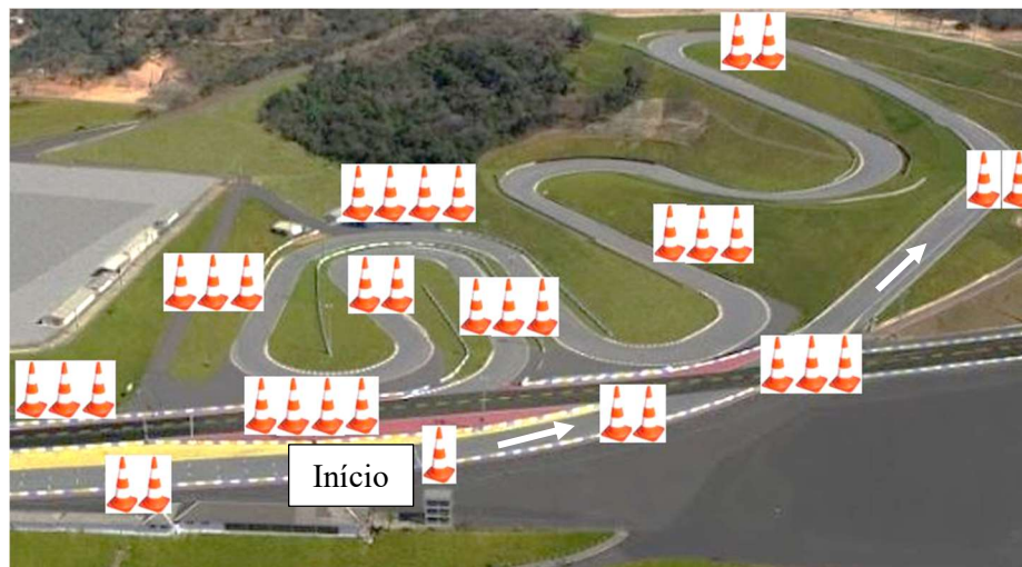
Figura 1: Vista aérea da pista utilizada para a medição do consumo e indicação dos pontos de troca e de marcha inserida (cones).
